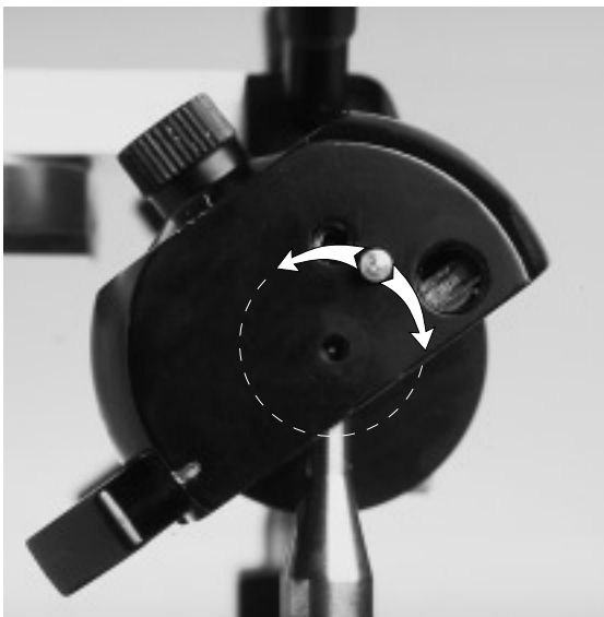
Abbildung 3.3-47: Zur schädelbezüglichen Übertragung der Oberkieferposition war daher bei früheren Artikulatorkonstruktionen eine systemkonforme Positionierung der Kondylargehäuse erforderlich (im Beispiel des Artex AL: Einstellung der Kondylenbahnneigung auf 0^\circ )
